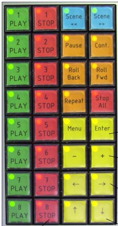
Die ENTER Taste wird auf einigen Display Seiten zur Bestätigung von Einstellungen benutzt, auf der Hauptseite kann man damit jedoch zwischen Text Anzeige und Hauptseite wechseln.
